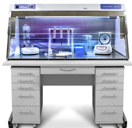
Стол T-4L, с ПЦП-боксом UVT-S-AR, тумбочками LF-1 и оборудованием для выделения нуклеиновых кислот
