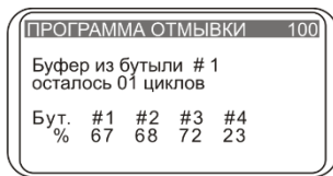
Рисунок 8. Дисплей при работающей программе и с подключенным терминалом контроля объема жидкости
